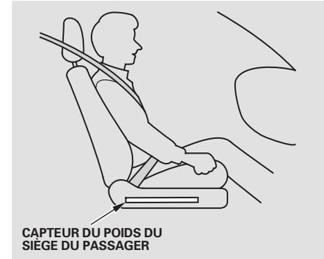
Le système intelligent du coussin gonflable avant du passager comporte des capteurs du poids sous le siège. Bien que Honda ne recommande pas qu'un bébé ou qu'un enfant de petite taille prenne place à l'avant, si les capteurs détectent qu'un bébé ou qu'un enfant de petite taille (jusqu'à environ 29 kg ou 65 livres) est sur le siège, le système annulera automatiquement le coussin gonflable avant du passager.
