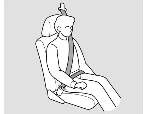
Faire passer la partie sous-abdominale de la ceinture le plus bas possible en travers des hanches, puis tirer sur le boudin pour bien ajuster la ceinture. De cette façon, le bassin amortira la force lors d'une collision et réduira les risques de blessures internes.
