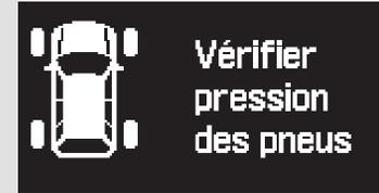
Un capteur de la pression est incorporé dans chaque pneu. Si la pression d'un pneu baisse substantiellement, le capteur de ce pneu envoie immédiatement un signal qui fait allumer le témoin de la basse pression des pneus/TPMS dans le tableau de bord. Dans ce cas, le pneu dont la pression d'air est basse paraîtra sur l'affichage multi-information avec le message "Vérifier pression des pneus".
