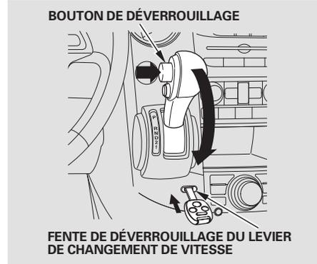
4. Insérer la clé dans la vente de déverrouillage du levier.
