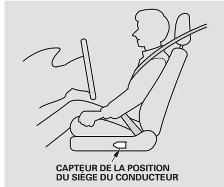
Le système avancé du coussin gonflable avant inclut un capteur de la position du siège sous le siège. Si le siège est trop avancé, le coussin gonflable se déploiera avec moins de force, peu importe la gravité du choc.
