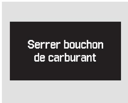
Le système de diagnostic à bord du véhicule détectera un bouchon du réservoir à essence manquant ou desserré en tant que fuite du système d'évaporation. La première fois qu'une fuite est détectée, un message "Serrer bouchon de carburant" paraîtra sur l'affichage multi-information. Couper le contact et confirmer que le bouchon du réservoir est en place. S'il l'est, le desserrer et le serrer de nouveau jusqu'à au moins un déclic. Le message devrait disparaître après
