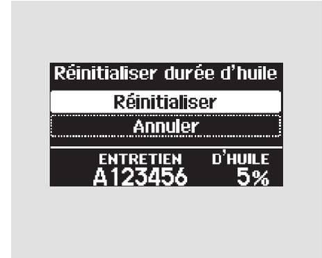
3. Appuyer de manière continue sur le bouton "SEL/RESET" sur le volant pendant plus de 10 secondes. Le mode de la durée utile de l'huile à moteur paraîtra sur l'affichage multi-information.
