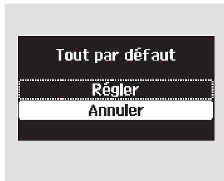
Pour programmer les réglages par défaut de nouveau, appuyer sur le bouton INFO (▲/▼) pour choisir Régler puis appuyer sur le bouton "SEL/RESET".
