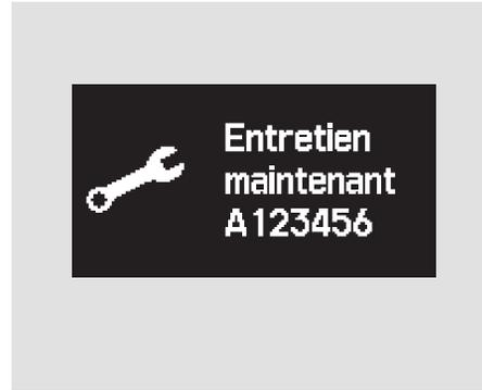
Quand la durée utile de l'huile à moteur est de moins de 5 pour cent, on verra l'affichage ci-dessus. L'affichage passe à "Entretien maintenant". L'entretien indiqué doit être effectué le plus tôt possible.
