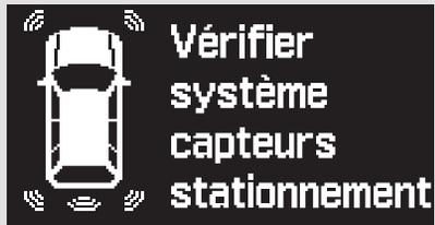
Si le système est défectueux, le message "Vérifier système capteurs stationnement" paraîtra sur l'affichage multi-information.
