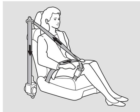
Pour une protection accrue, les ceintures de sécurité avant sont équipées d'enrouleurs automatiques. Quand ils sont activés, les enrouleurs tendent immédiatement les ceintures afin de retenir le conducteur et le passager avant en place.
