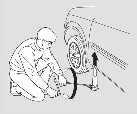
16. Tourner la molette du cric (clé pour écrous de la roue) vers la droite, tel que représenté, pour lever le véhicule jusqu'à ce que le pneu crevé soit loin du sol.
