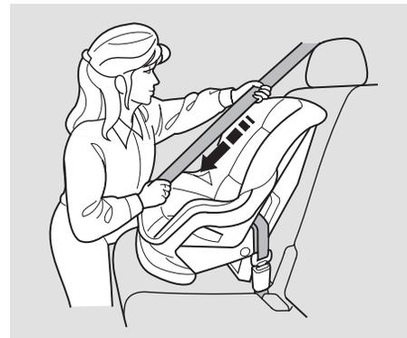
2. Pour faire fonctionner l'enrouleur à verrou, tirer lentement le baudrier complètement hors de l'enrouleur jusqu'à l'arrêt puis laisser la ceinture s'enrouler.
