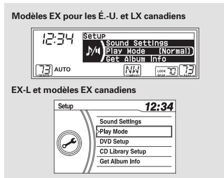
On peut choisir n'importe quel type des modes de répétition, aléatoire et de balayage en utilisant le bouton CONFIGURATION et le bouton sélecteur. Appuyer sur le bouton CONFIGURATION pour afficher les articles du menu puis tourner le bouton sélecteur pour choisir "MODE DE LECTURE". Appuyer sur le bouton sélecteur pour programmer la sélection.
