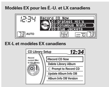
Insérer un CD qui n'a pas été enregistré dans la CDthèque, appuyer sur le bouton "SETUP" (CONFIGURATION) et tourner le bouton sélecteur à "Configuration CDthèque" et appuyer sur le bouton sélecteur. Sélectionner "ENREGISTRER CD MAINTENANT" et appuyer sur le bouton sélecteur. L'affichage passera à la liste des albums. Sélectionner l'emplacement désiré et appuyer sur le même bouton pour commencer l'enregistrement.
