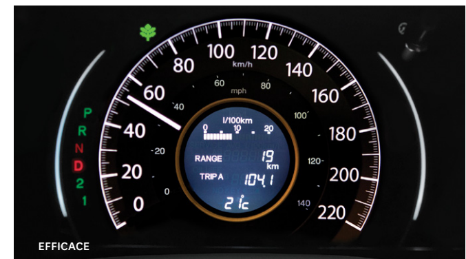
Le système d'aide à la conduite écologique (Eco Assist MC ) vous guide pour que vous conduisiez de façon plus efficace en changeant les bandes colorées de chaque côté de l'indicateur de vitesse.
